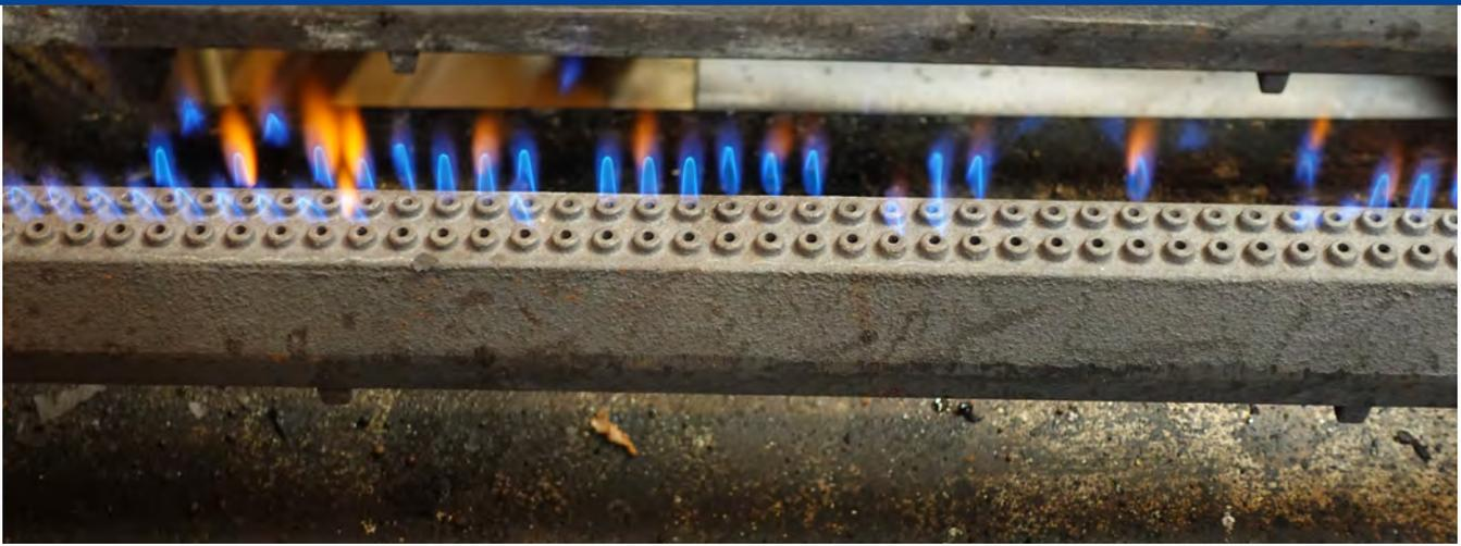
inmediatamente a un profesional calificado. La combustión dentro del tubo mezclador no recibe suficiente aire y por ende es incompleta, lo que produce olores y hollín que pueden obstruir el interior del quemador. Una situación común en los quemadores de las cocinas comerciales es la acumulación excesiva de grasa o residuos en el interior del quemador, lo que puede ralentizar la mezcla de aire y gas natural y provocar un retroceso de la llama.
