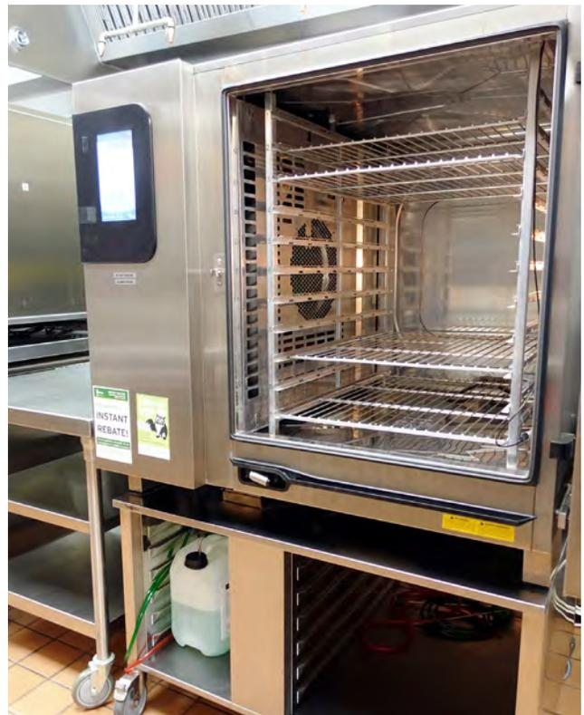
Los hornos combinados sin caldera utilizan un sistema de inyección de vapor como el de los hornos de bandejas, en el que el agua se convierte en vapor instantáneamente al entrar en contacto con las piezas calientes y se inyecta en la cavidad.
