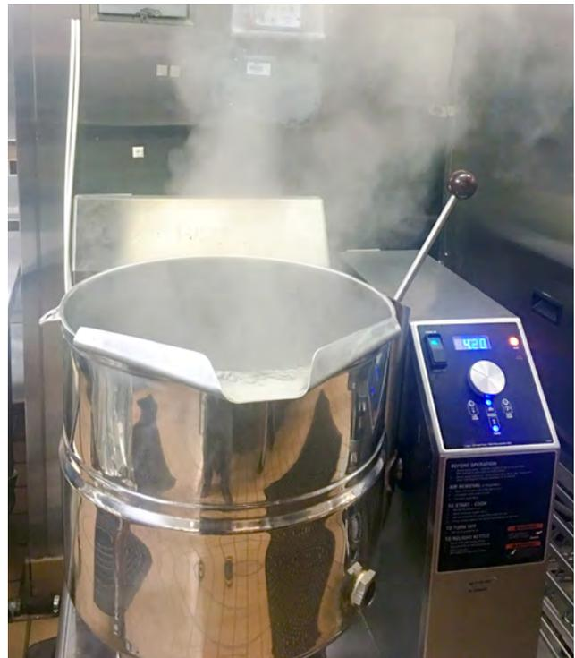
**Advertencia de seguridad:** El vapor es invisible y puede causar quemaduras graves; utilice gafas de seguridad y proteja la piel expuesta al abrir la válvula de seguridad. Los operadores de estos equipos pueden considerar el uso de un cobertor de la camisa como elemento de seguridad adicional. Estos cobertores se apoyan en el borde de la tetera como una capa de aislamiento y protección para el operador.
